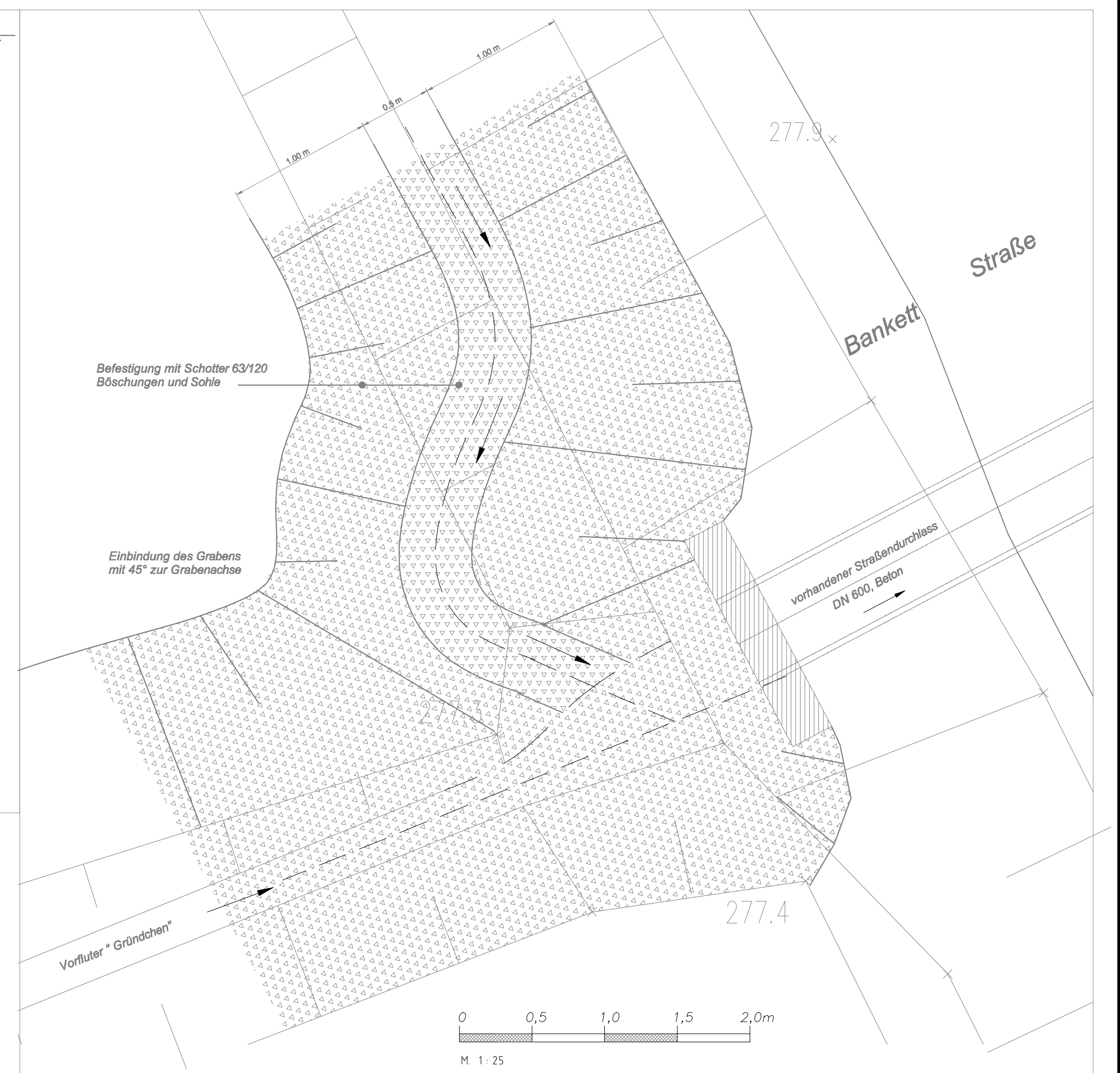
Detail 2 Eileitung in die Vorflut Ausbau und Befestigung der Einleitstelle
